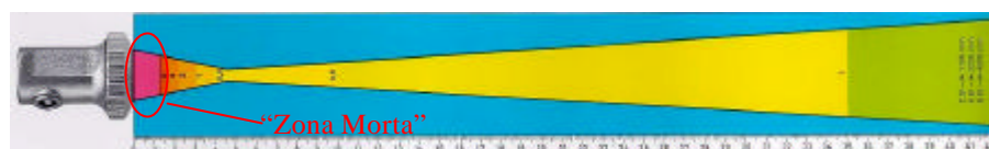
Figura 7. Sonograma característico de transdutor convencional
