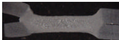
Figura 19 .Secção transversal de Ponto de Solda Queimado por excessiva indentação
