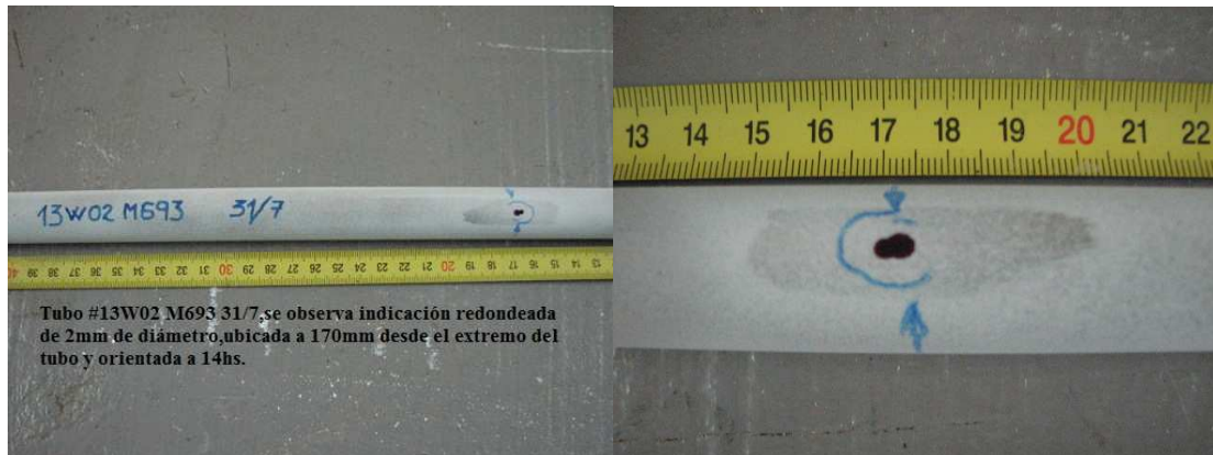
Figura 6. Indicación pasante por LP del tubo fila 31 columna 7.
