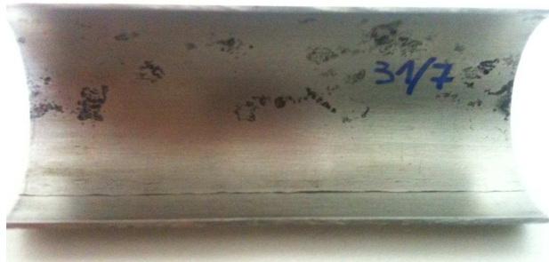
Figura 1. Tubo 31/7. Defectología en pared interna del tubo
