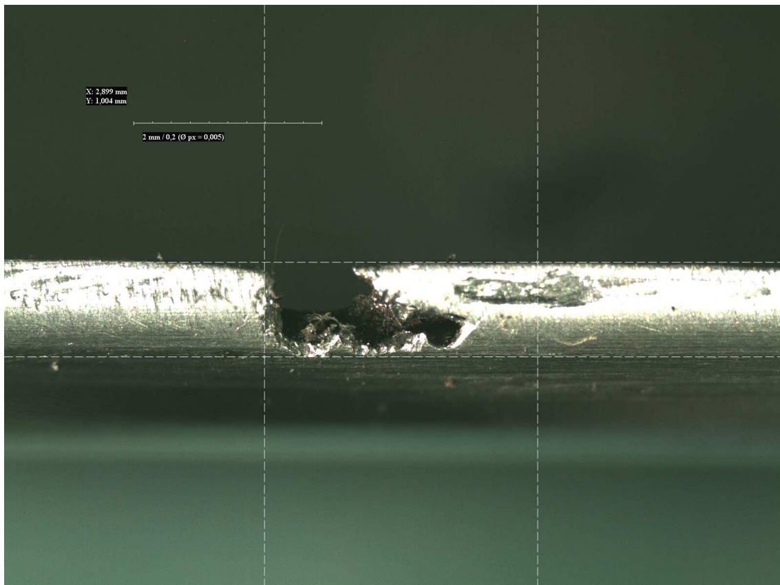
Figura 11. Vista de defecto pasante con lente 2x del tubo fila 31 columna 7 luego del pulido metalográfico.
