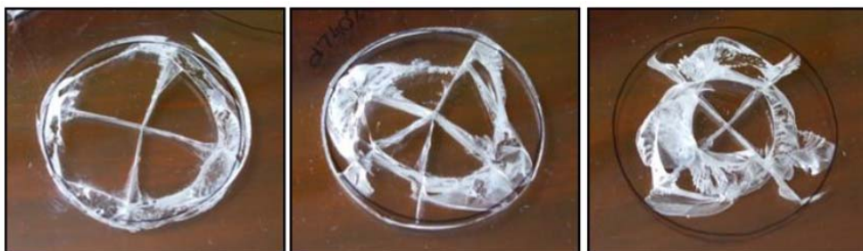
Figura 4. Curvas fuerza vs desplazamiento y patrones de rotura de PMMA ensayado con un dardo 20 mm y un soporte de 40 mm.
