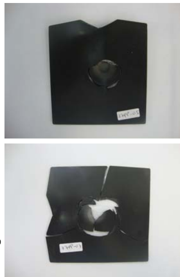
Figura 9. Fuerza vs desplazamiento y patrón típico de rotura obtenidos en ensayos de impacto biaxial de placas de PP copolímero a -30°C.
