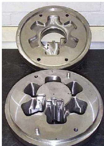
Figura 4. Matriz tubular de tipo puente
