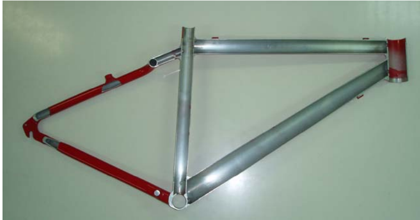
Figura 3. Corte de un cuadro de bicicleta. Se aprecia la diferencia de sección y de espesor de pared en los diversos tubos que conforman el cuadro.
