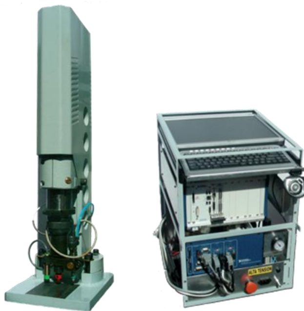
Figura 5: Equipo de Ensayo – ESYS 10. Indentador (izquierda) y conjunto adquirente y controlador (derecha)
