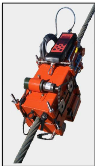
Fig. 2 – Dispositivo de elevación para equipo de inspección de cables
